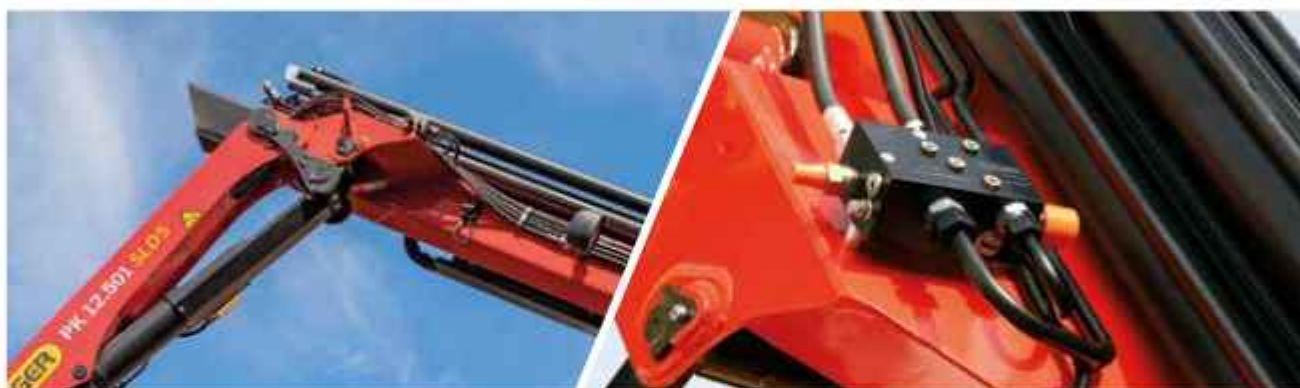
Palanca acodada en el brazo articulado Más fuerza en el gancho.
